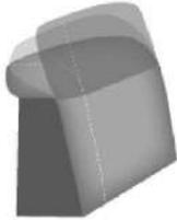
Auf Führungsschienen gelagerte, stufenlose Rückenverstellung mit Faltenoptimierung.
