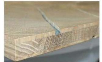
Der Aufbau zeigt die massive Mittelschicht und die beidseitigen 4 mm starken Deckschichten
