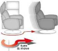
Durch integrierte Rollen im Drehteller lässt sich der Sessel einfach verschieben. Funktion darf nur zum Schieben des Sessels genutzt werden. Rollen müssen zum Sitzen immer eingefahren werden.
