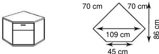
Eck-Deckblatt wird separat geliefert, muss vor Ort montiert werden. Über Eckteile kein durchgehendes Abdeckblatt möglich.
